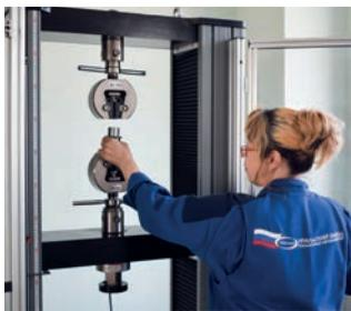
Во избежание проблем несоответствия металла заявленному сертификату УЗПМ АНТ проводит полноценный входной контроль, что включает сертификационный анализ, оценку прочности металлов, сплавов и сварных соединений. Для этого на заводе есть лаборатория с необходимым испытательным оборудованием.
