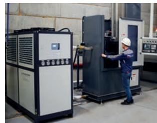
Установка закалки деталей
